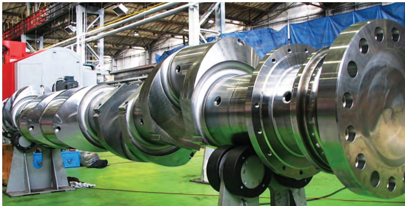
Wał korbowy monolityczny po finalnej obróbce mechanicznej Monolithic crankshaft after final machining
